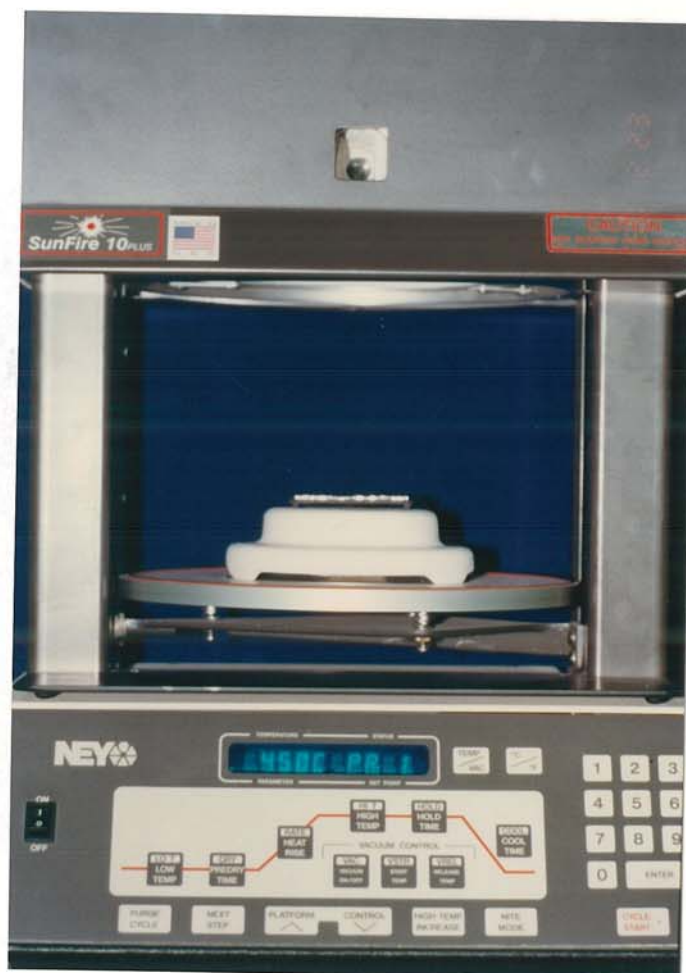
照片 18 用以進行金屬試片陶瓷烘烤週期的烤爐 SUNfire 10PLUS (NEY U. S. A)
