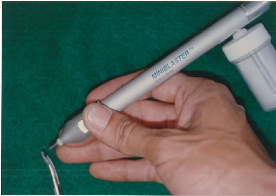
照片 19 使用噴砂機 MINIPLASTER (DELDENT Ltd., Petach Tikva, ISRAEL) 對金屬試片作表面噴砂處理
