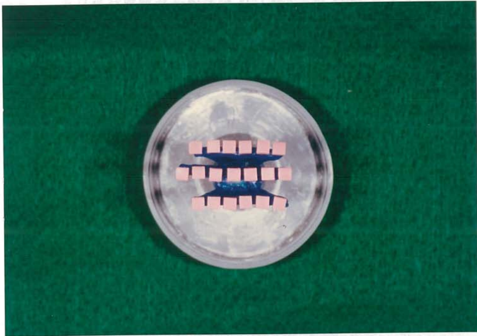
照片 4 用來鑄造純鈦金屬的鑄道設計 (鳥瞰圖)
