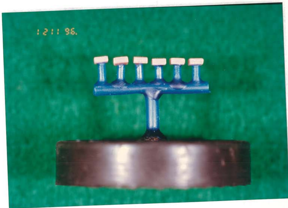
照片 2 用來鑄造鎳-鉻-鈹金屬合金的鑄道設計 (側面觀)
