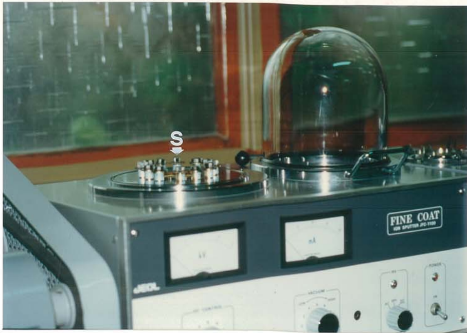
照片 31 使用 FINE COAT ion sputter JFI-1100 (JEOL Tokyo Japan) 為鏡檢標本(S)作 Au coating
