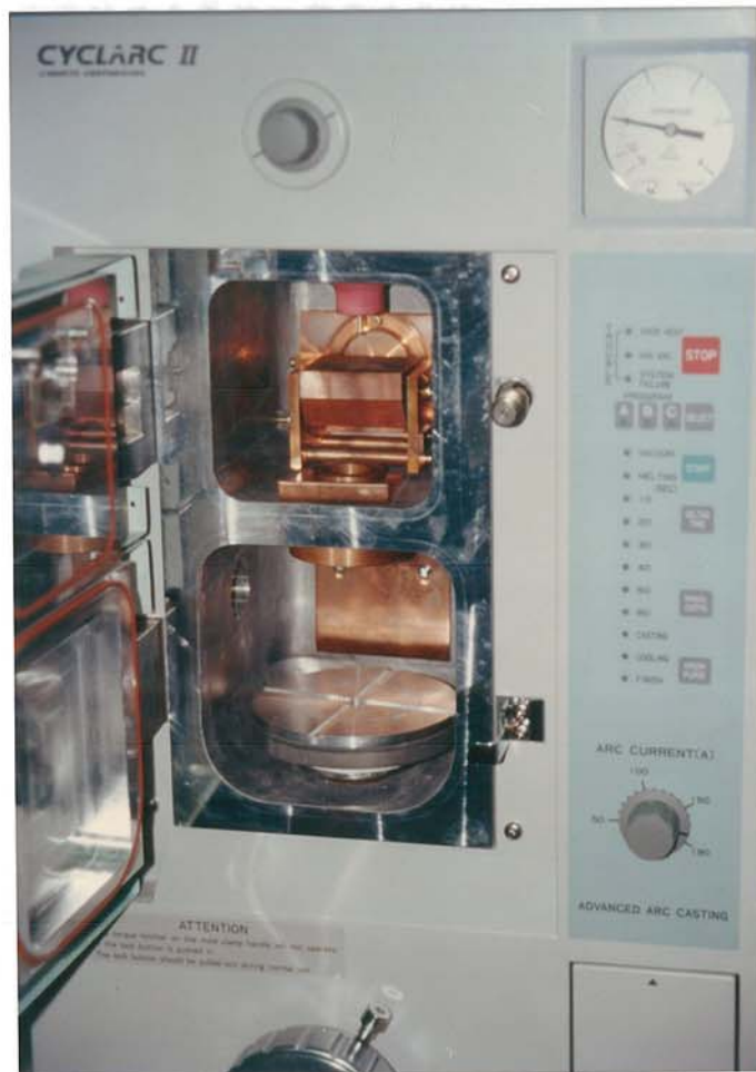
照片 8 用以鑄造商用純鈦金屬的鑄造機器 CYCLARC II (J. MORITA Co., Japan)
