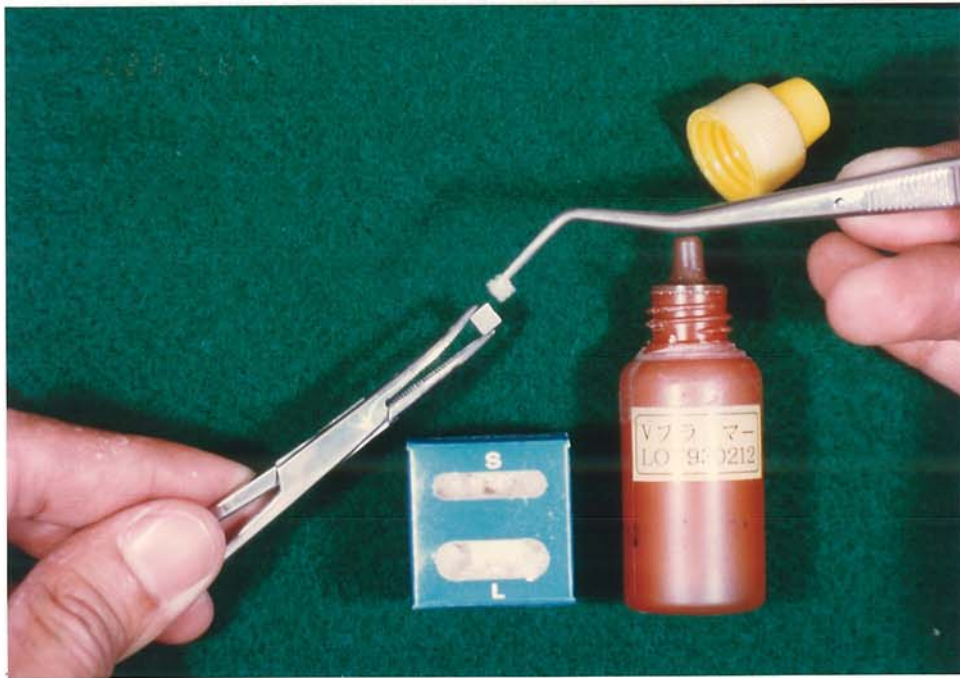
照片 20 使用 V-primer (SUN MEDICAL Co., Ltd. Kyoto Japan) 塗佈金屬試片表面
