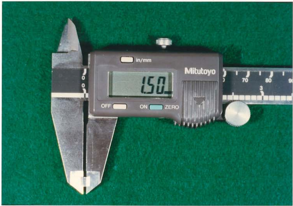
照片 13 使用數位化測量尺規 Digimatic Caliper (Mitutoyo Japan) 以統一規格化金屬試片，高為 1.50 mm
