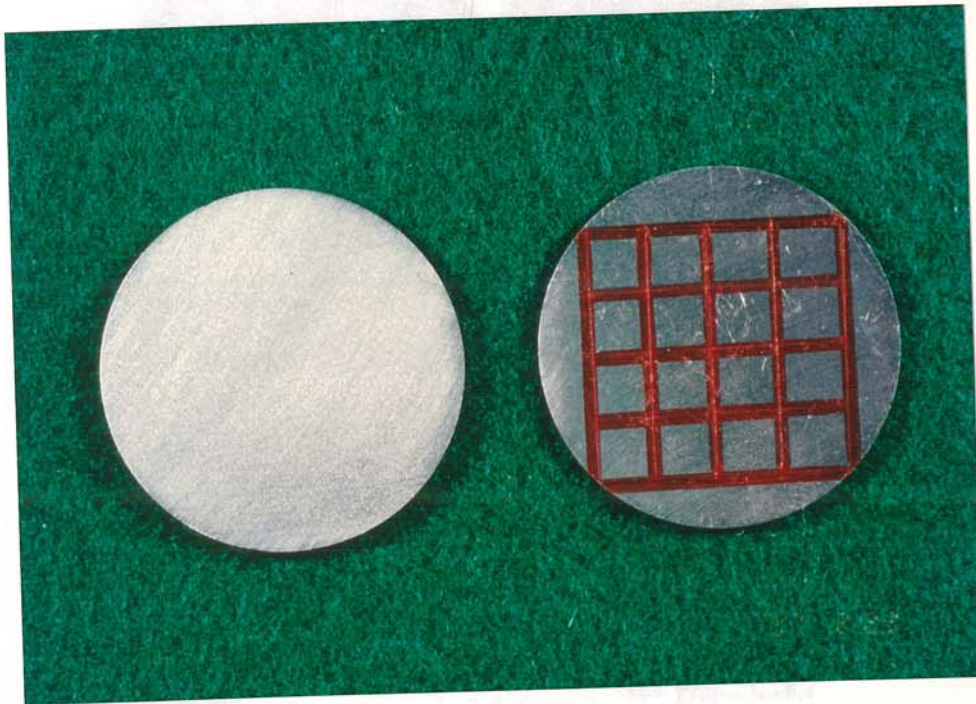
照片 16 劃格等分鑄塊純鈦金屬薄切圓片成 16 小格
