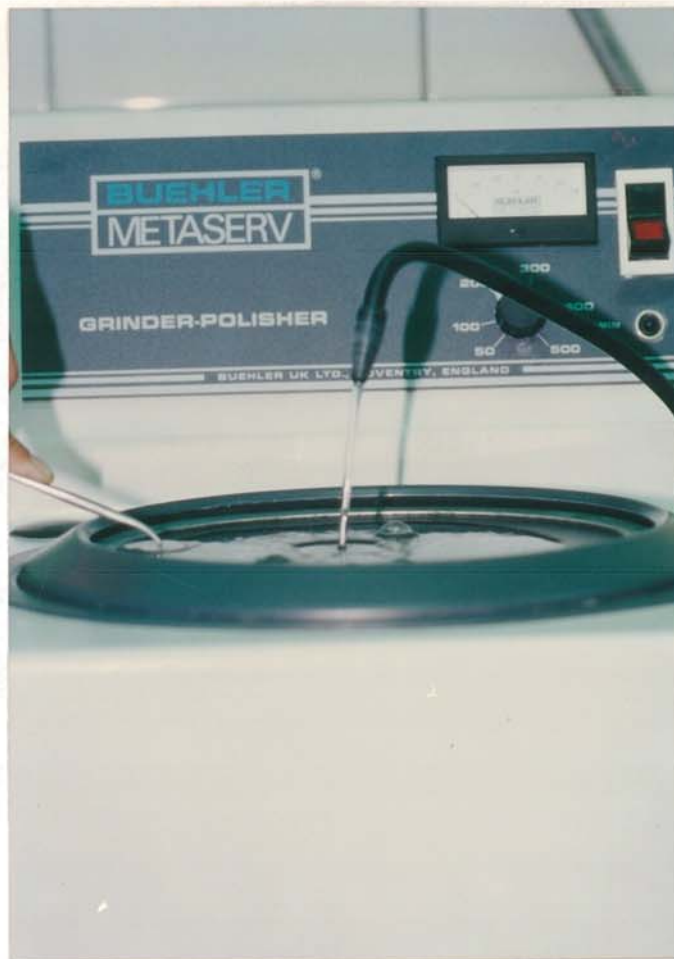
照片 11 使用研磨機 METASERV (BUEHLER UK Ltd., Coventry England) 以精確修磨鑄造金屬試片
