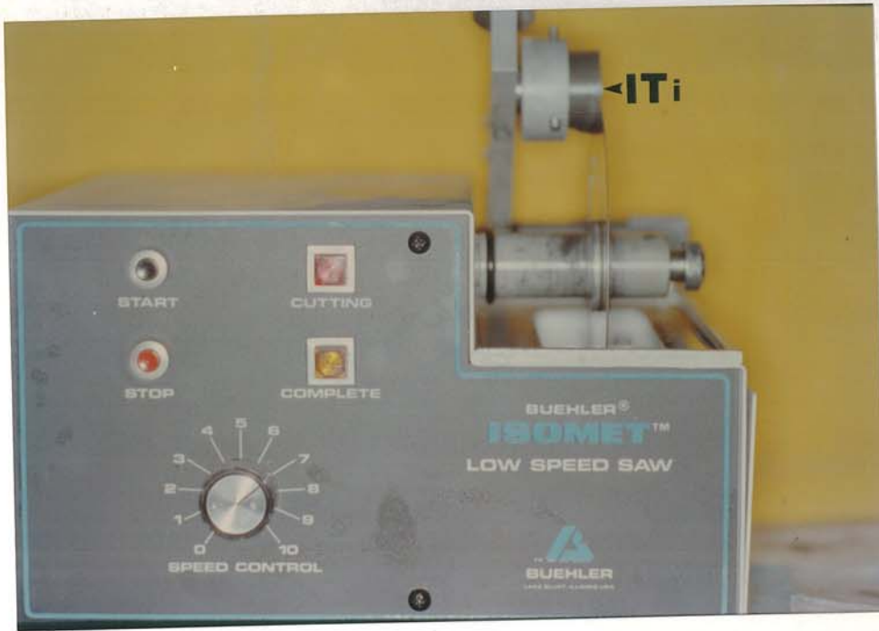
照片 15 使用切割機 ISOMET (BUEHLER U. S. A) 以薄切鑄塊純鈦金屬 (ITi)
