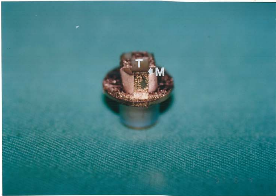
照片 32 已完成 Au coating 的鏡檢標本，Tooth(T) Metal(M)
