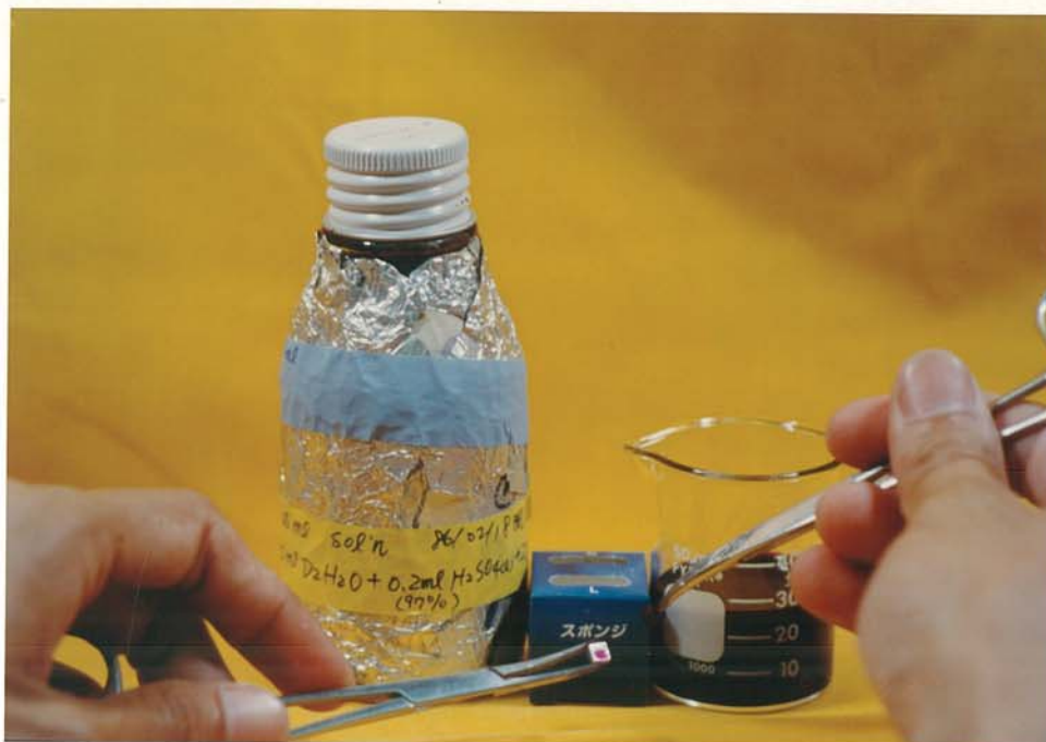
照片 21 欲將金屬試片浸潤到過錳酸鉀溶液，進行金屬試片表面氧化處理
