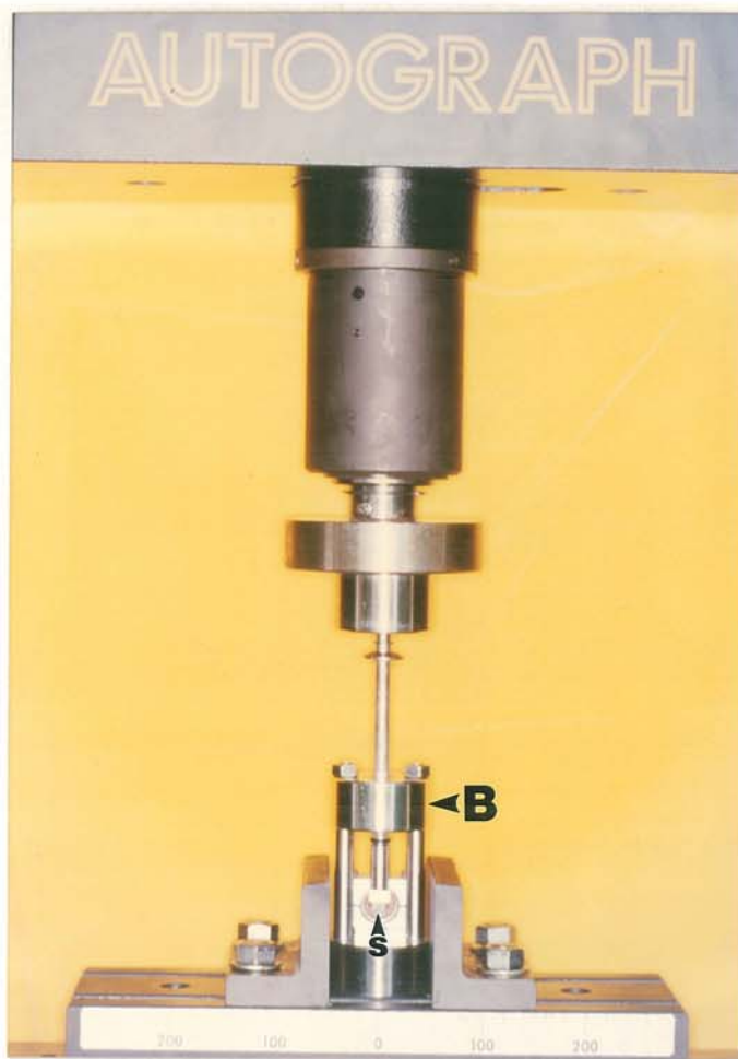
照片 27 實驗標本(S)置於 BENCORMULTI-T(B)中接受萬能測試機的施力
