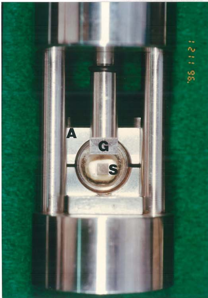
照片 26 實驗標本(S)置於 shear assembly (A)中將接受 shear guillotine(G) 的剪力
