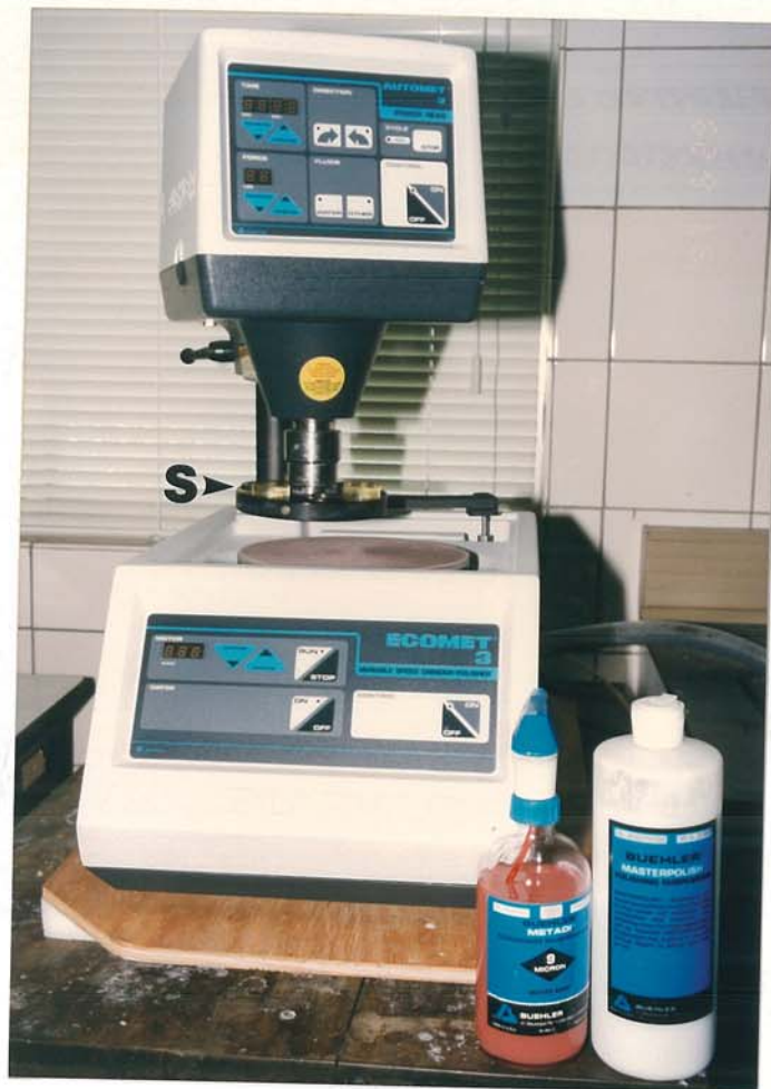
照片 29 實驗標本(S)作電子顯微鏡觀察前的修形與磨光
