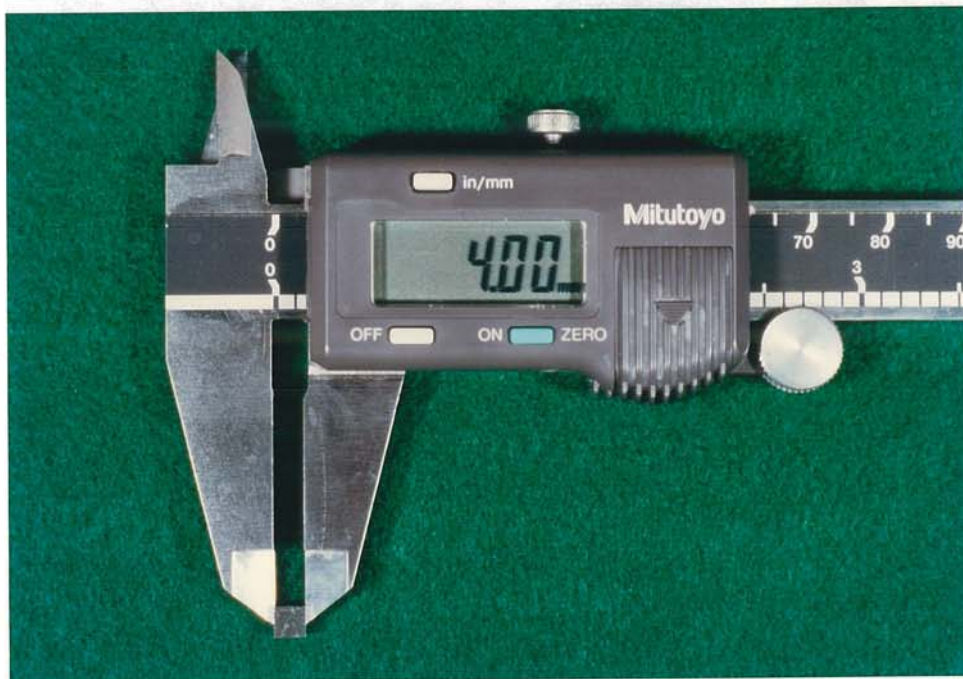
照片 12 使用數位化測量尺規 Digimatic Caliper (Mitutoyo Japan) 以統一規格化金屬試片，長寬皆為 4.00 mm
