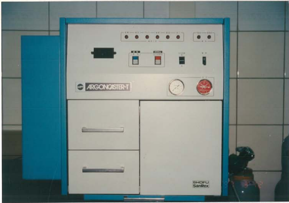
照片 7 用以鑄造鎳-鉻-鈹金屬合金的鑄造機器 ARGONCASTER-T (SHOFU Inc., Japan)
