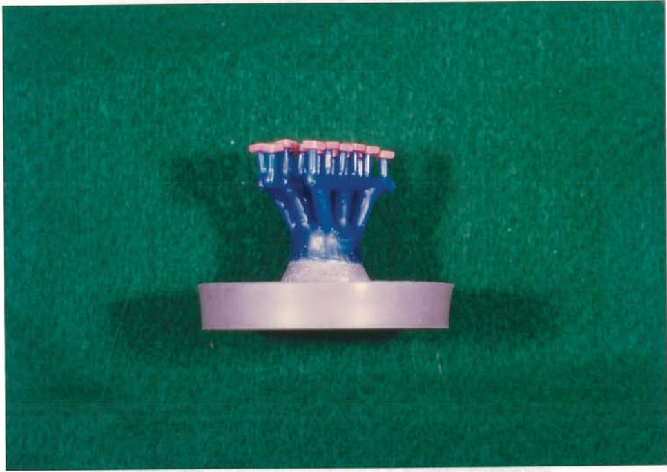
照片 3 用來鑄造純鈦金屬的鑄道設計 (側面 45° 觀)
