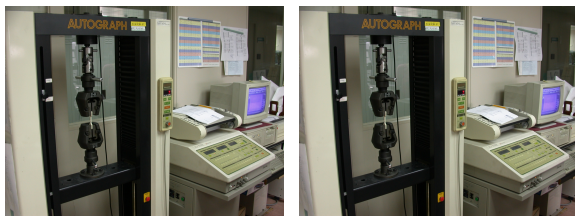
圖八 材料測試機及骨試片夾合固定情形
