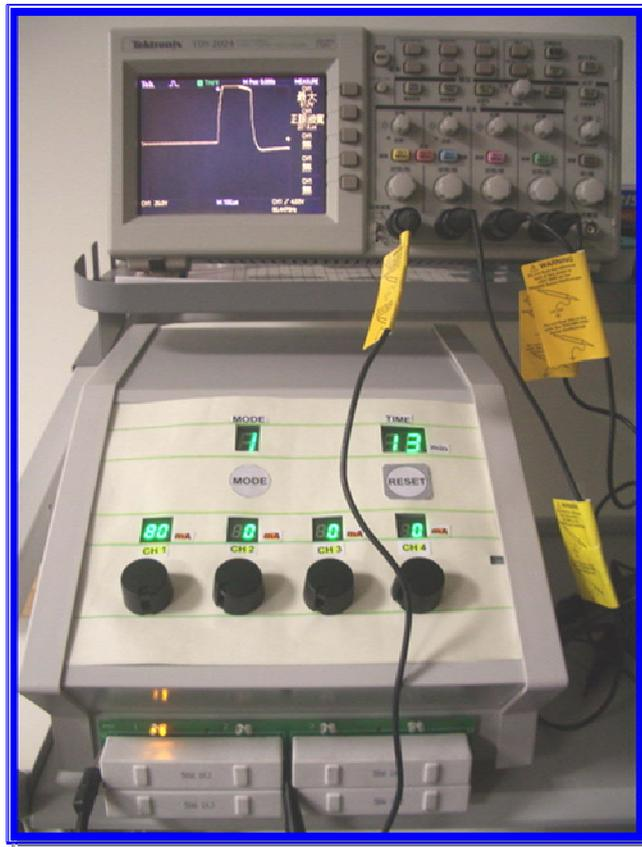
圖 16 吞嚥電刺激神經輔具系統測試方式
