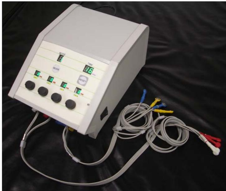
圖 15 吞嚥電刺激器系統外觀圖
