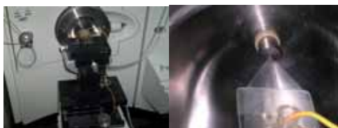
圖10 (左)微電噴灑晶片架設於LCQ質譜儀前(右)晶片與加熱毛細管(取樣孔)處之放大圖
