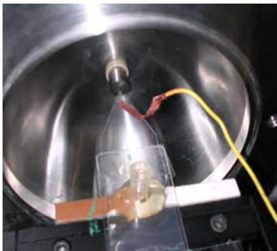
圖 2 非接觸式電極之微電噴灑電泳晶片
