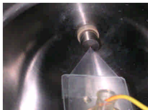
圖八 (上)微電噴灑晶片架設於LCQ質譜儀前(下)晶片與加熱毛細管(取樣孔)處之放大圖
