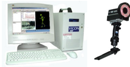
圖 2 動作分析系統 (Vicon 460 Motion System) 及紅外線高速攝影
