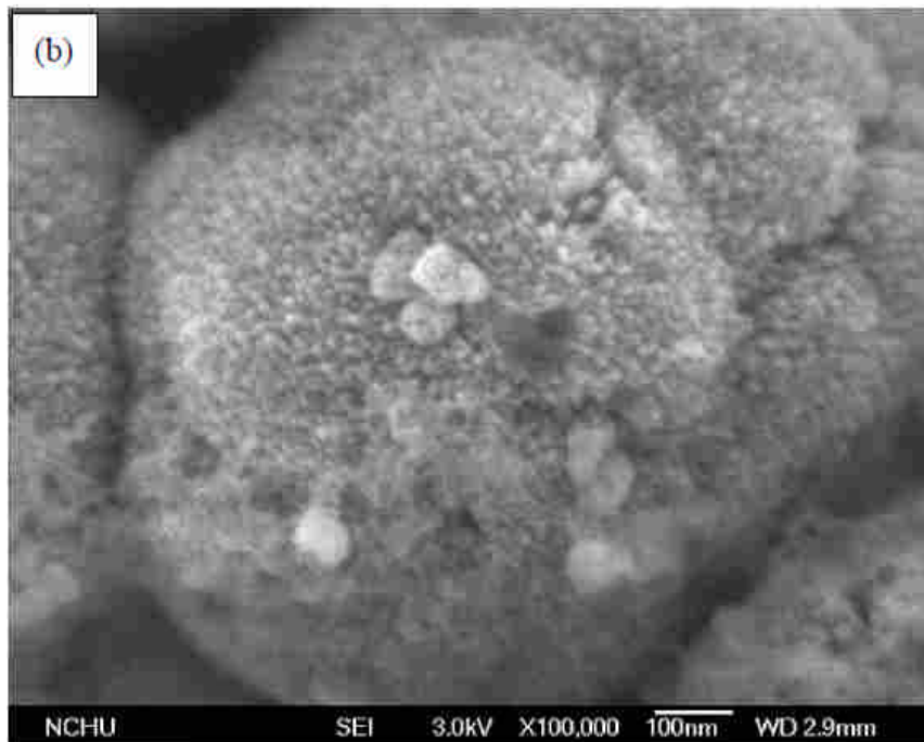
圖 7.1 不同 Ti-Si 比例光觸媒 FESEM 圖: (a)10%Ti-Si (b) 30%Ti-Si (c) 50%Ti-Si (d) 70%Ti-Si
