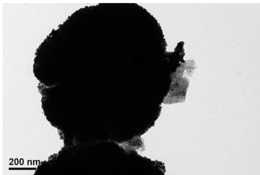
圖 5.9 Pt/30% Ti-Si 光觸媒 TEM 圖
