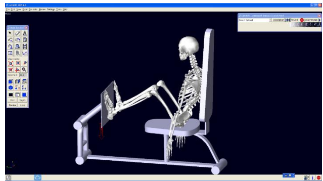
圖十三、建立之腿部推蹬訓練機3D CAD 骨架模型與在Adam+LifeMod 人體肌肉骨骼系統模擬模型之建立
