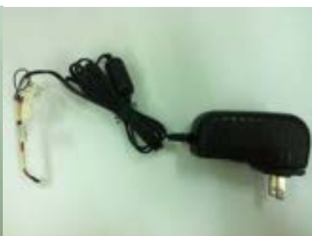
圖 8、電池充電設備
