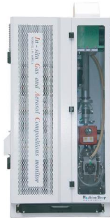
圖 3.3-1 現址式氣體與氣溶膠組成監控系統
