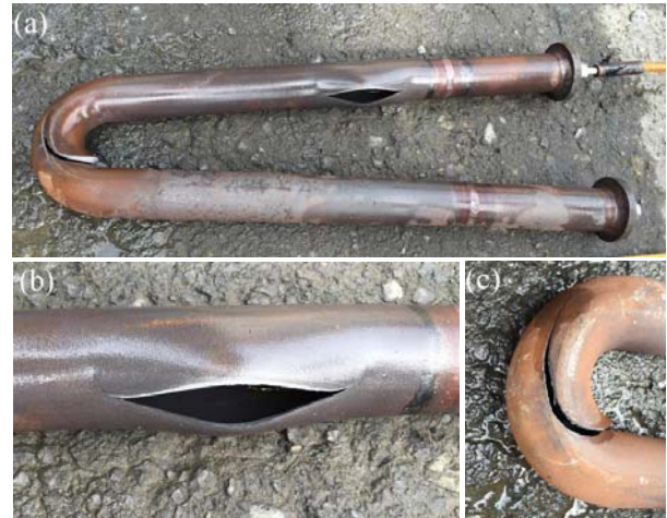
圖十二、SA213-T91 經噴珠且應力釋放處理管材冷彎管之水壓爆破試驗後外觀圖，(a)試驗後整體外觀圖，(b)直管部位破裂圖，(c)彎管部位破裂圖。
