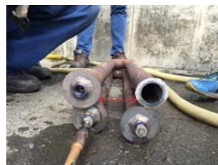
圖十四、SA213-T91 合金鋼管應力釋放處理後，經水壓爆破試驗冷彎管與未經水壓試驗管材之比較圖。
