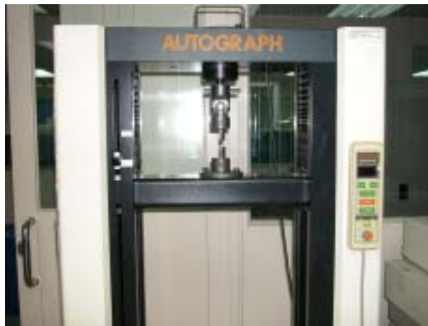
圖 12a. 試棒置於萬能試驗機上進行抗拉試驗
