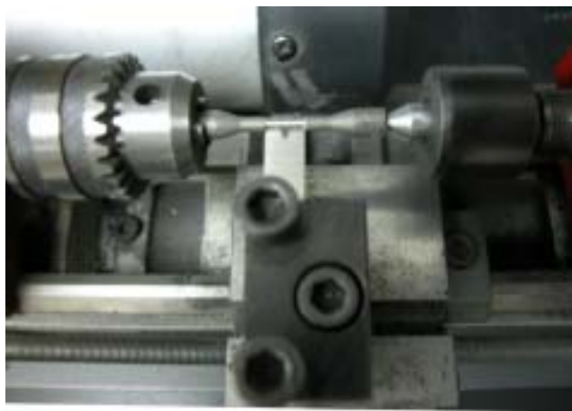
圖 10. 置於車床上修磨熔接處之試棒
