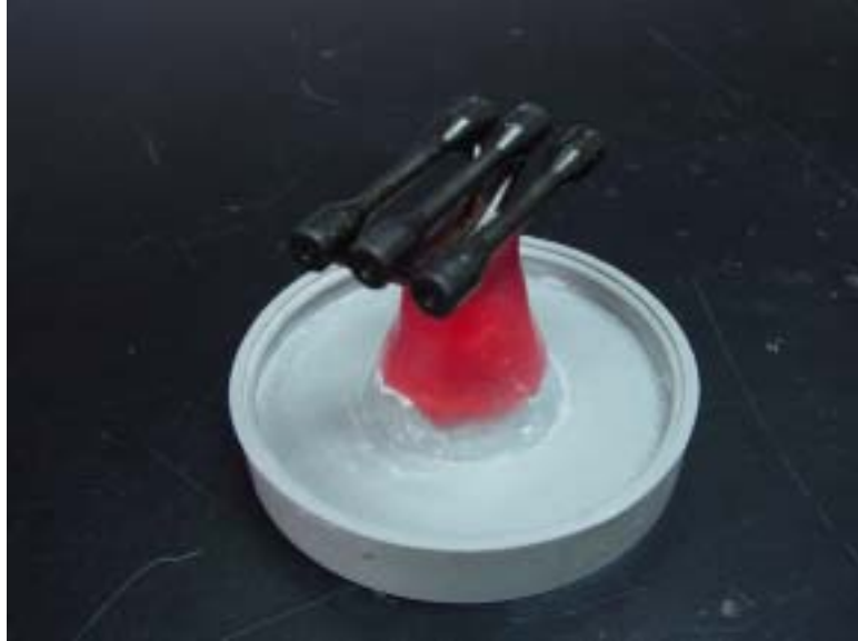
圖 2. 固定於鑄造圓錐台上之三根壓克力試棒
