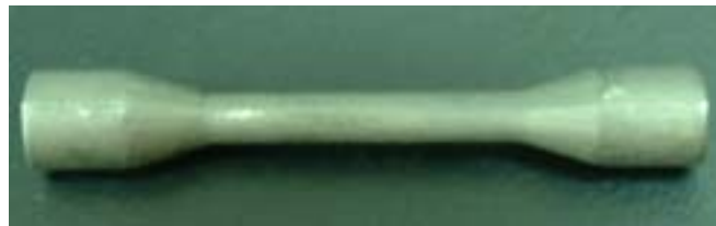
圖 6. 修磨完成之鈦金屬試棒
