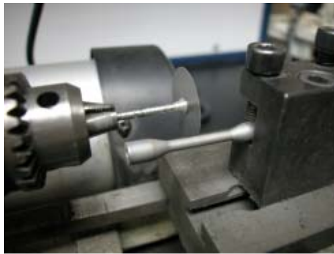
圖 7. 將鈦金屬試棒固定於標準夾具上切成兩半
