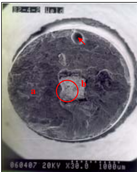
圖 29. 1_290_9_2, weld joint, x30 a. 雷射熔接區, b. 未熔接區
