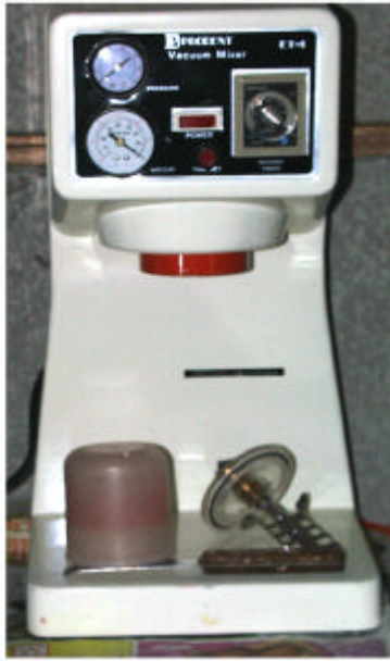
照片 13：石膏真空調拌機
