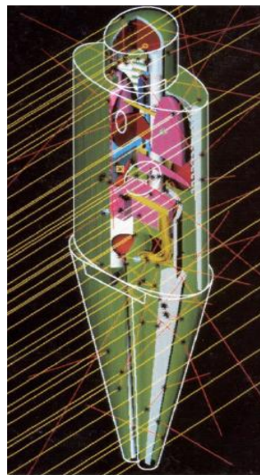
圖三(b):自行研發假體 (self-developed phantom)之數學設計
