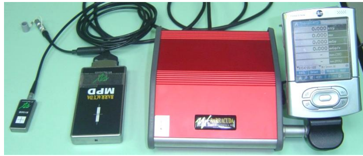
圖一 Barracuda MPD 偵檢器，紅色盒為 RTI electronics AB meter，以 PDA 顯示。
