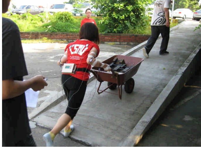
圖 10 受試者推雙輪推車之實驗情形
