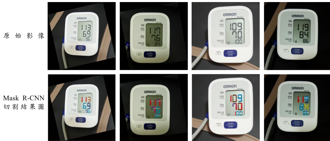
圖 1、Mask R-CNN 切割七段顯示數字之結果
