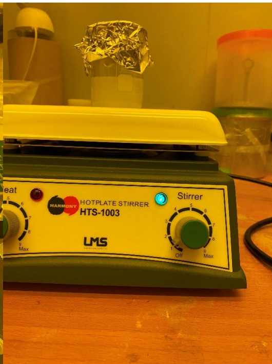
紀錄電磁攪拌機的刻度以求每次轉速相同
