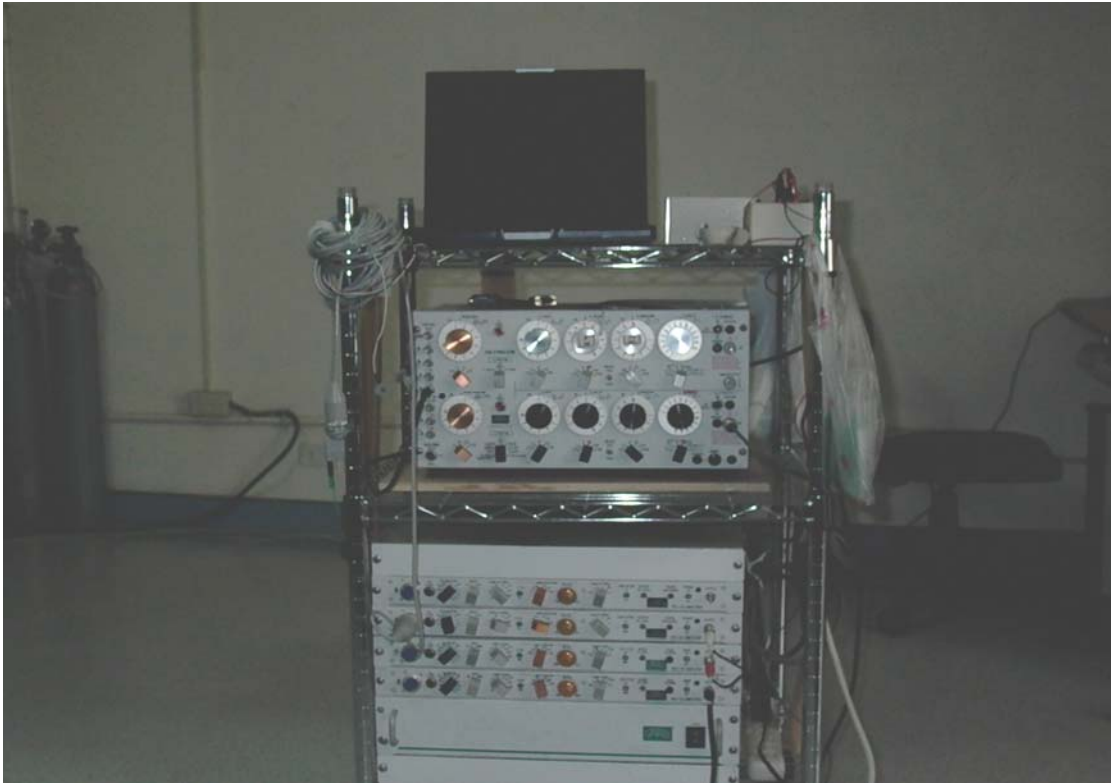
圖二、H 反射電刺激器及生理訊號率波放大器
