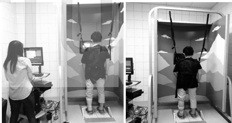
圖 1 以 Smart Balance System 測試穿戴不同踝足矯具之姿勢穩定度
