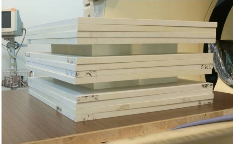
圖四、將三層 4cm 水假體與兩層 PMMA 線對假體交互堆疊
