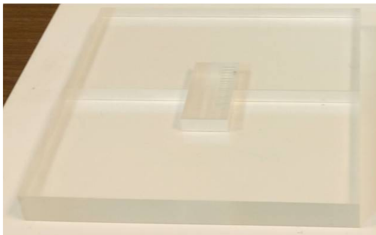
圖六、第四層 PMMA 線對假體依 SI 方向擺放
