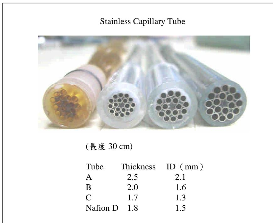
圖一：不銹鋼毛細管與 nafion 管之尺寸示意圖。
