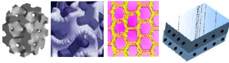
圖 二-15 沸石之結構示意圖。由左至右分別為：球狀立方堆積、六角堆積、立方堆積及層狀結構。
