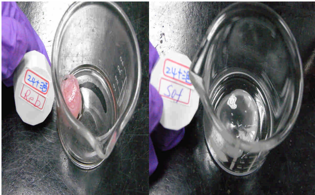
圖六(左、REB 牙材經 37°C(24、48、72 小時)酒精處理後呈現粉紅色膨脹軟狀易散開；右、SOF 牙材經 37°C(24、48、72 小時)酒精處理後呈現透明帶白色圓餅狀)
