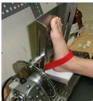
圖 1 自製踝關節牽張力矩調整器
