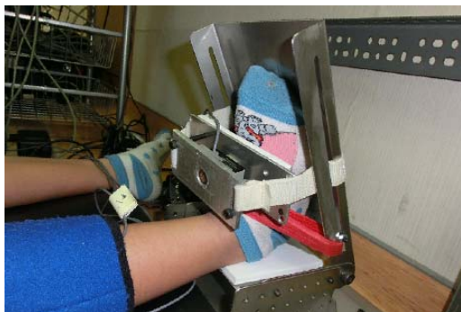
圖 7 孩童接受力矩與肌電回饋電刺激控制系統電刺激訓練
