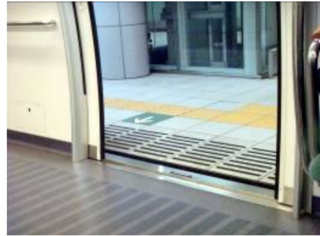
車廂與月台的高度同高且間隙小，高齡者及輪椅者易於進出，提高安全性
