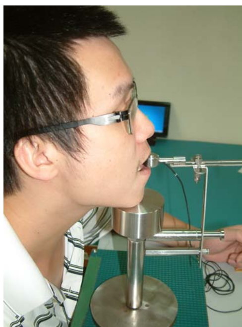
圖 10 頰唇運動障礙評估暨唇壓誘發感知回饋電刺激顏面復健平台硬體設計架構及測試
