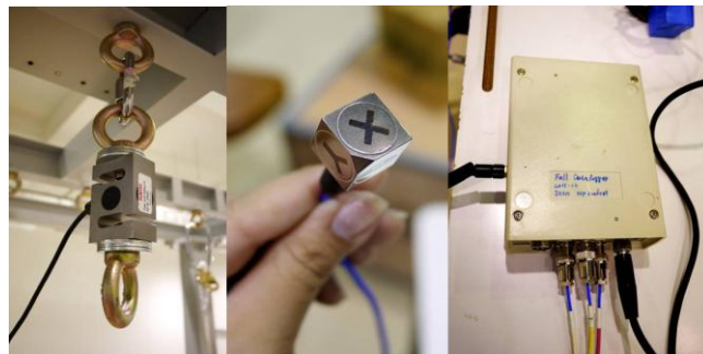
圖 2 測量繩索張力之荷重計、測量加速度之 3 軸向 ICP 加速度規、記錄器
