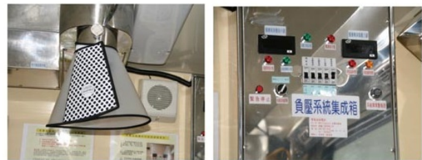
▲這具負壓系統是車上最重要也最耗電的裝置，能把車空氣排出車外，讓救護人員不受病患傳染。
