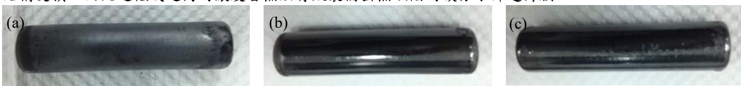
圖 3-12 不同鑄膜液濃度之管柱式碳分子篩選薄膜 FESEM 圖：(a) M8-1-6(T)、(b) M10-1-6(T)、(c) M12-1-6(T)
