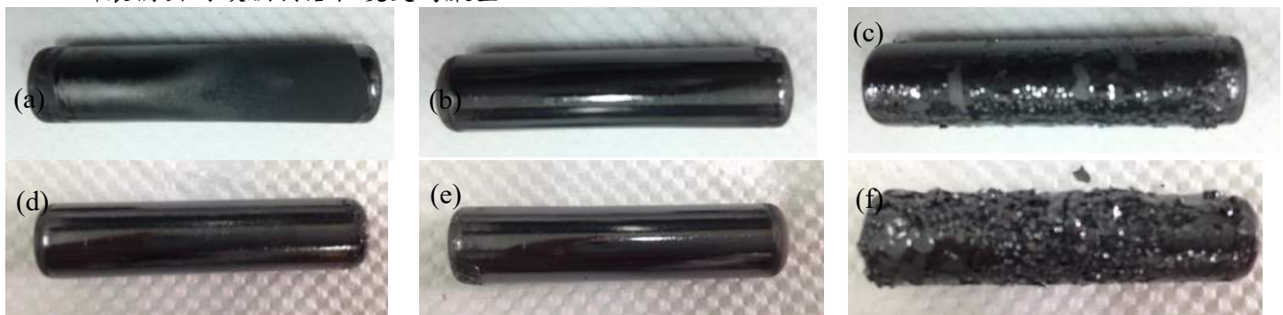
圖 3-9 不同浸沒抽出速度、塗佈次數之管柱式碳分子篩選薄膜外觀圖：(a) M10-1-5(T)、(b) M10-1-6(T)、(c) M10-1-7(T)、(d) M10-10-5(T)、(e) M10-10-6(T)與(f) M10-10-7(T)
