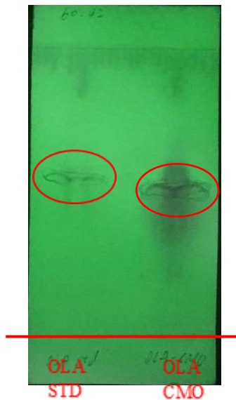
Figure 11. 利用 TLC 觀察 OLA-CMO 衍生結果
