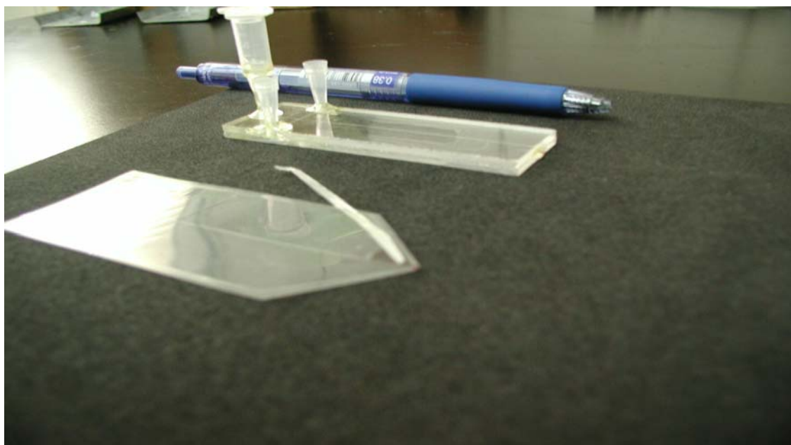
圖 3-11 一般(上)與自行研發之薄層(下)塑膠-電泳質譜晶片之比較圖
