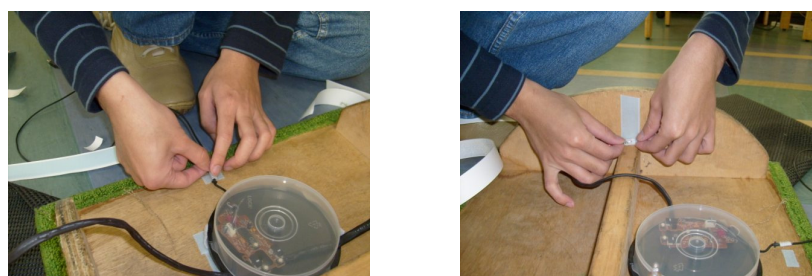
圖 3、圖 4 將滑鼠電路板以水銀開關固定於平衡板下方
