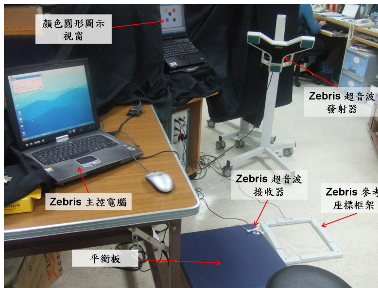
圖 13 實驗場地設備設置圖
