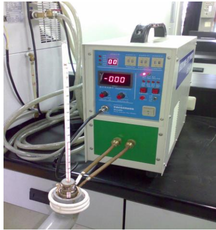
圖 3. 本實驗使用的高周波感應加熱設備
