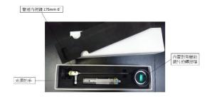
攝影系統之構造,定位出了必須具備的項目,如:同軸光源、可加入輔助鏡片改變焦距、輕便、可改變光源特性(不同波長濾片)、方便手持與觀察等。經過一系列的資料蒐集與討論,最後發現工業用的管道內視鏡符合大多數的需求,價格接受度也較高。另外,醫療規格的內視鏡也符合本計畫之需求,但考量到成本與計畫先導實驗的規格,最終選定在符合預算的前提下能發揮最高功能的工業規格管道內視鏡。
