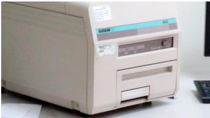
圖四 計讀熱發光劑量計接受輻射曝露後吸收劑量的計讀儀
