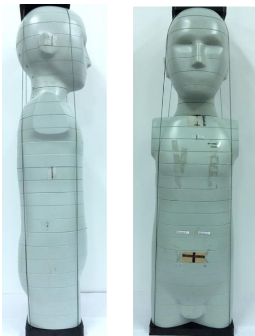
圖二 實驗模擬五歲小孩之假體正面(右圖)與側面(左圖)影像
